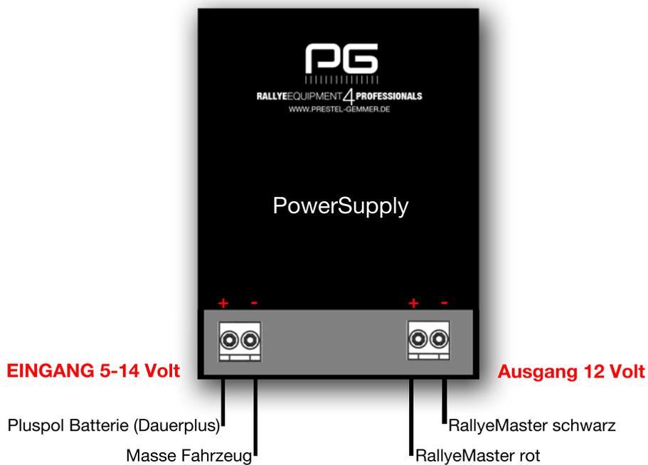
**Bitte befestigen Sie das PowerSupply an einer freien Stelle im Fahrzeug so, dass keine mechanische Beanspruchung des Gehäuses stattfindet.**
